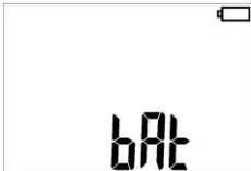
Die Batterien müssen gewechselt werden, bzw. die Akkus müssen geladen werden!
