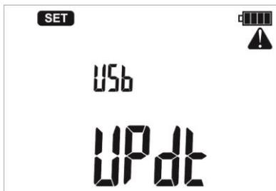
Nach dem Anschluss des Messgerätes an einen Computer über das USB-Kabel, befolgen Sie die Anweisungen des Programms.
