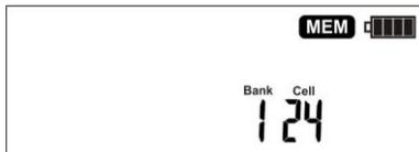
Änderung der Nummer der Zelle wird mit den Tasten ▲ und ▼ durchgeführt, und der Datenbank mit den Tasten ◀ und ▶.
